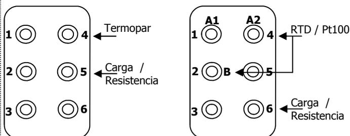
En el extremo del cable de salida se instala un conector multipolar. La conexión estándar es:
